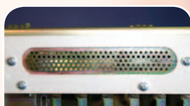
Dvě záslepky pro případnou montáž speciálních konektorů
