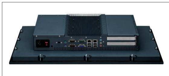
Obr. 2. Nexcom 2160P má všechna běžná počítačová rozhraní
