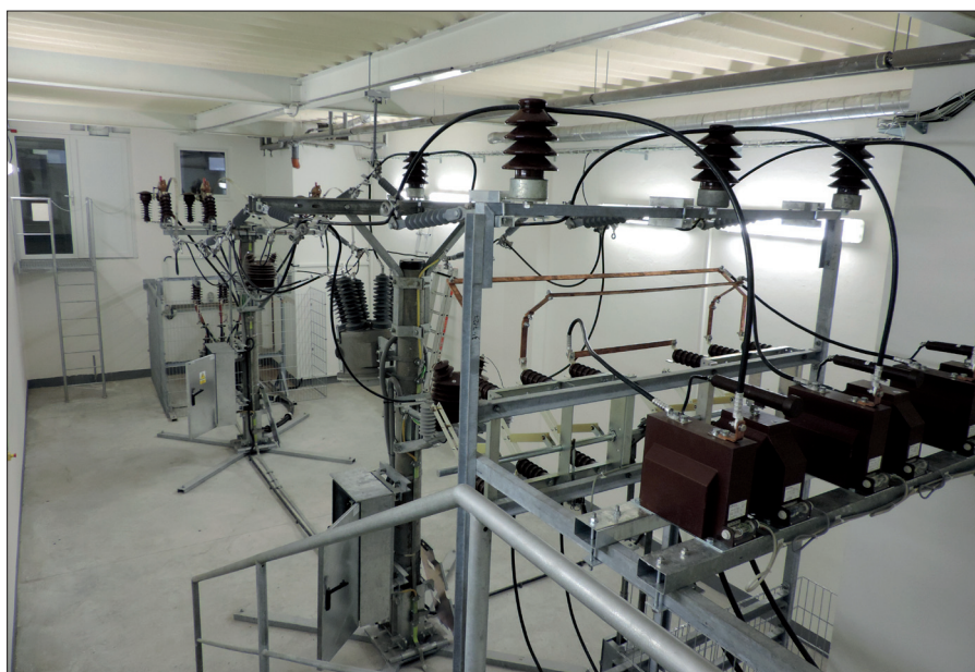
Obr. 1. Vysokonapěťový model distribuční sítě
