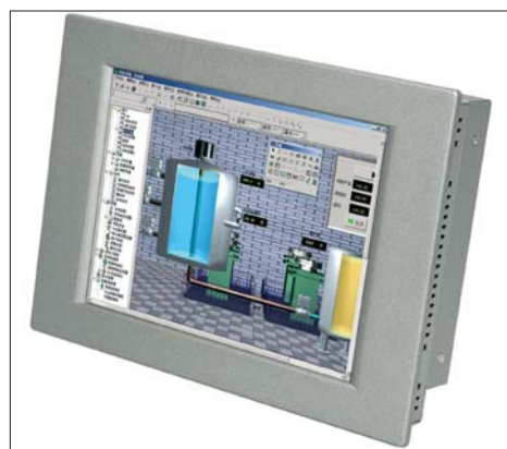
Obr. 5 Panelové počítače typu HMI
