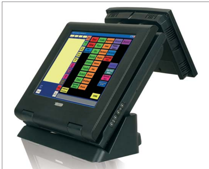
Obr. 3 EP-162 – k terminálům řady EP-16 lze připojit další monitor, počítač je prostorově úsporný a jeho efektivní pasivní chlazení zajišťuje tichý provoz bez přehřívání
