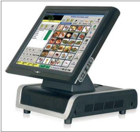
Obr. 4 EP-267 – flexibilní design systémů POS EP-26 umožňuje nastavit do vhodného pozorovacího úhlu primární dotykovou obrazovku i přídatný monitor, bohatá výbava komunikačním rozhraním nabízí snadné rozšíření o mnoho dalších funkcí
