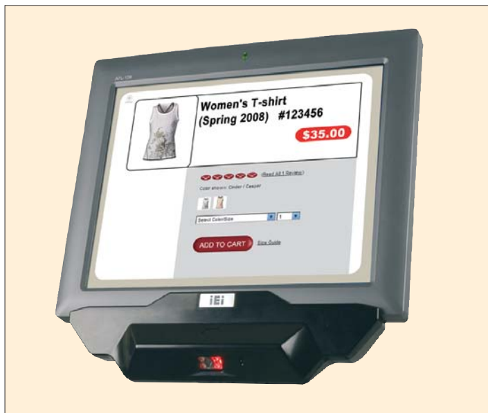
Obr. 1 AFL-12B – POS počítač s dvanáctipalcovou dotykovou obrazovkou a zabudovaným snímačem čárových kódů
