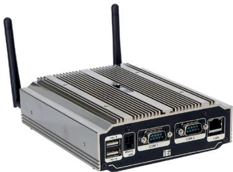
Obr. 2 UIBX-210 minimalistické řešení s dvojitým srdcem třetí generace od Intelu
