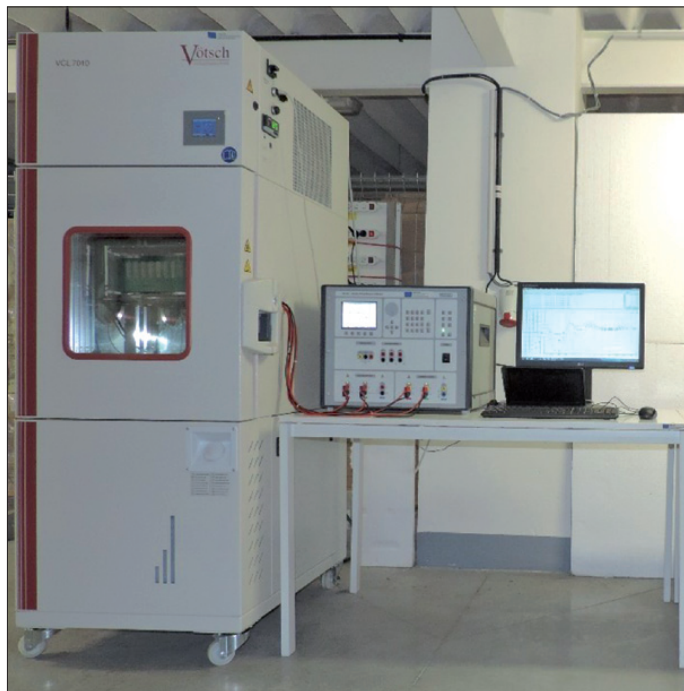
Obr. 1 Průběh testování EP karet (proces teplotní kompenzace) v klimatické komoře Vötsch VCL 7010 (vlevo)
