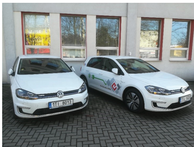
Obr. 1 Elektromobilita v ELVAC – dva nové elektromobily VW e-Golf (akumulátor: 35,8 kWh; 100 kW / 290 Nm; 150 km/h; spotřeba: 12,7 kWh na 100 km jízdy)
