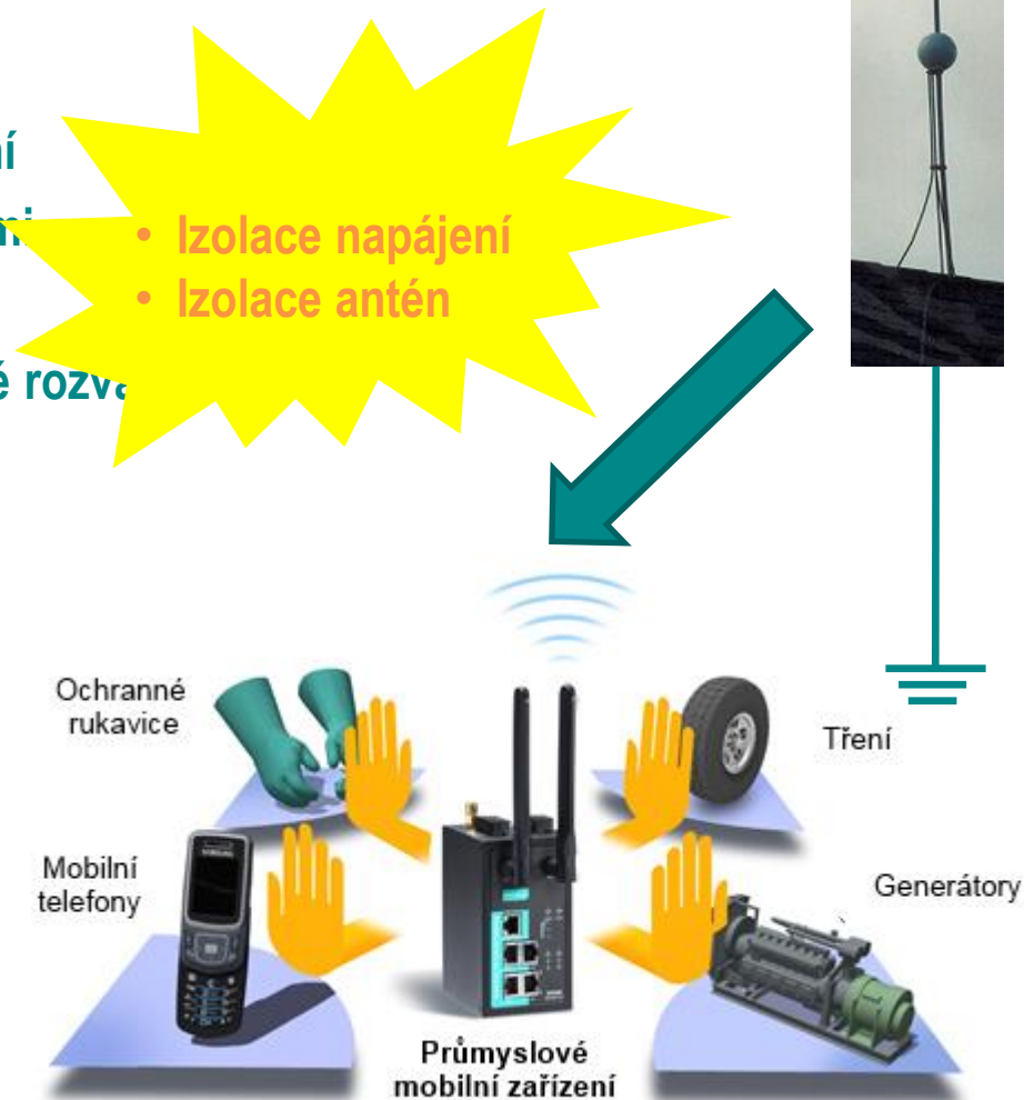
Zdroje elektromagnetického rušení
