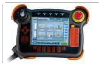
Obr. 4 Prenosný operátorský terminál Robot-TP65M
