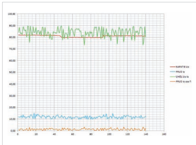
Obr. 9 Príklad poruchového záznamu – výsledkom je signalizácia žltej LED RESULT
