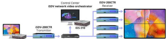
Snadné nasazení díky přepínání funkcí Tx a Rx v jednom zařízení
