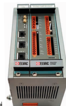
Příklad distribuovaného řešení RTU7M – kompletní ochrany se širokými komunikačními schopnostmi
