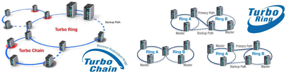
Ukázky rychlých redundantních topologií podporovaných přepínači Moxa
