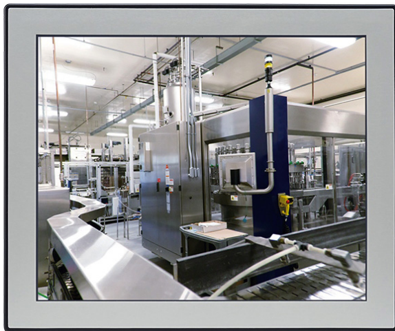
Přední dotykový panel splňuje krytí IP65 a má poměr stran 4:3
