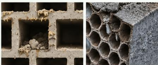
Zanesené keramické lože (RTO) Vrstva SiO 2 na katalyzátoru zvýšení tlakové ztráty, až mechanické poškození omezuje kontakt s aktivním povrchem
